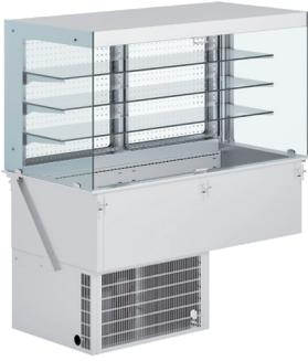
**Vitrinas cúbicas** refrigeradas con puertas abatibles posteriores. Cuba aislada de 115 mm de profundidad con la base regulable en altura. Eficiente sistema de refrigeración ventilado. **Diseño mejorado.** Temperatura de trabajo en la cuba: 0 °c / 4°c. En zona de vitrina abierta: 4°c / 10°c.
