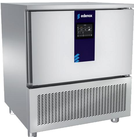
**Abatidores-congeladores rápidos** controlados electrónicamente. Ciclos medidos según norma EN17032. Ciclo abatimiento: +65°C a +10°C en 120 minutos. Ciclo congelación: +65°C a -18°C en 270 minutos. Interior fabricado en acero inoxidable. Gas-refrigerante ecológico **R-290** libre de CFC.
